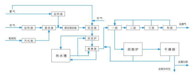
气相法白炭黑主要是通过化学气相沉积法,又称热解法、干法或燃烧法制得。其原料一般为四氯化硅、空气和氢气,空气和氢气分别经过冷却脱水、硅胶干燥、除尘过滤后送入合成水解炉。将四氯化硅原料送至蒸发器中加热蒸发,并以干燥、过滤后的空气为载体,送至合成水解炉。四氯化硅在高温下气化后,与一定量的氢和空气在高温下进行水解;此时生成的气相法白炭黑颗粒极细,与气体形成气溶胶,不易捕集,故使其先在聚集器中聚集成较大颗粒,然后经旋风分离器收集,再送入脱酸炉,用水蒸气和空气吹洗气相法白炭黑至pH值为3.8以上即为亲水白炭黑,用有机基团取代白炭黑表面羟基中氢使白炭黑能够浓于有机溶剂即为疏水气相法白炭黑。
