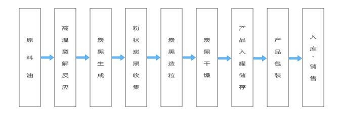
炭黑反应生成过程炭黑生产的核心是炭黑反应炉,燃料与空气先在反应炉的燃烧室完全燃烧产生高温烟气,并高速流经喉管。在喉管处,原料油由喷枪喷入反应炉,高温裂解反应生成炭黑及尾气。在此过程中,通过控制风、油配比、添加剂和 急冷装置来控制生成炭黑品种。炭黑反应生成过程的关键技术是反应的温度、时间及取向控制。反应温度的高低及反应时间的长短主要影响炭黑的性质,反应的取向决定原料油生成炭黑反应转化比例的高低。
