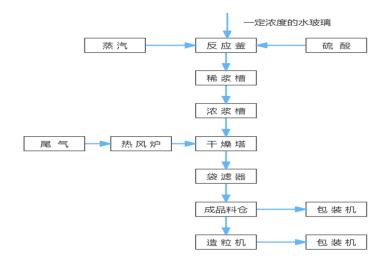
沉淀法白炭黑利用硅酸钠与硫酸反应制得,液体水玻璃加水调节到20%-30%的浓度送入下一道工序进行合成,在合成釜内先加入一定量的水和水玻璃,在80-90℃温度下,同时加入硫酸和水玻璃并搅拌而生成白炭黑浆料,将浆料进入压滤机进行压滤,并用清水洗去其中的硫酸钠再进入打浆槽制得浓浆,用炭黑尾气燃烧产生的烟气与空气热交换,得到500℃左右热风将经过雾化机雾化浓浆干燥为白炭黑粉末,用袋滤器收集后进行包装,根据需求,可将粉末状的白炭黑进行造粒,变成块状白炭黑进行包装销售。
